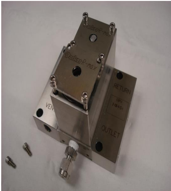
1.) Remove plate screws
